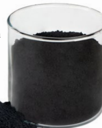
Bindmedel och pigment Kimrök från pyrolys processer blir ny råvara som bindemedel och pigment m.m.
