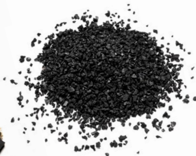
Isolerar, avlastar och gjuts Gummigranulat i fri form isolerar, avlastar, minskar slitage mm och i gjuten form bildas nya produkter. Som komponent i betong och asfalt förbättras egenskaperna.
