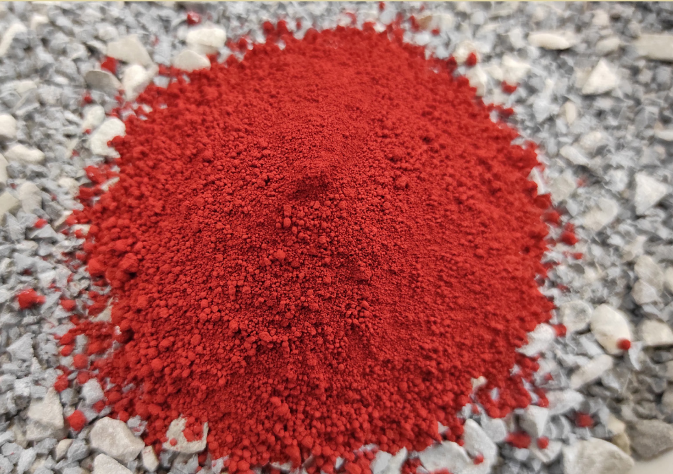
Tillsats av pigment i blandningen för att färga matrisen av materialet.
